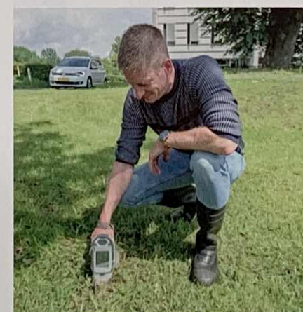
Met een XRF apparaat wordt de aanwezigheid van zware metalen in de toplaag gemeten.
